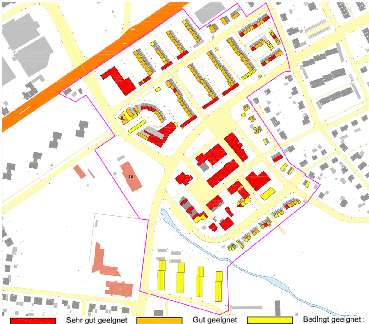
Abbildung 35: Fotovoltaik Potenzial<sup>1</sup>
